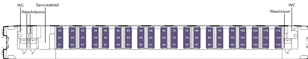
Figur 11.4: Exempel på en traditionell tysk liggvagn med 60 platser i 10 kupéer med sex bäddar eller sittplatser och dessutom tjänstekupé, två vestibuler och två WC samt tre tvättrum. Kupéerna i denna vagn är således mycket trängre både på bredden och längden än i den svenska vagnen ovan.
